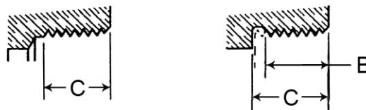
جدول شماره (۲-۷-۲-۳) "ب" (۸)، از استاندارد MSS SP-80:1997 حداقل طول و عمق دنده‌ها در شیرهای کشویی برنزی با اتصال دنده‌ای
